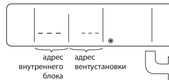
Адрес внутреннего блока и адрес вентустановки появляются на экране одновременно.
